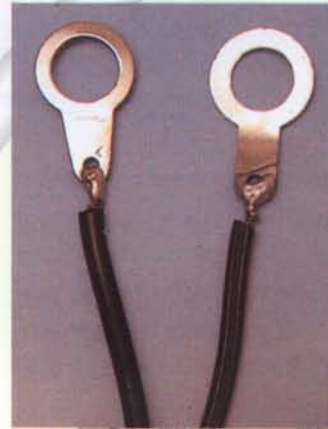
Figura 9.11. Soldadura de cables en terminales metálicos de conexión
